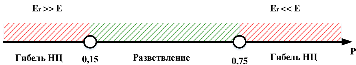
Рисунок 2.2 – Условие наступления разветвленно-цепных процессов горения углеводородов в замкнутом объеме
