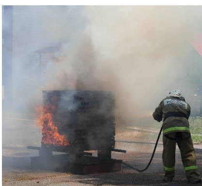
Рисунок 2.6 – Тушение струями температурно-активированной воды модельных очагов класса А (слева) и В (справа)
