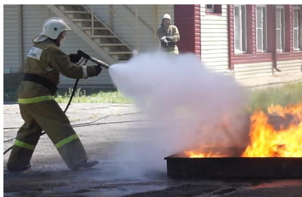
Рисунок 2.6 – Тушение струями температурно-активированной воды модельных очагов класса А (слева) и В (справа)
