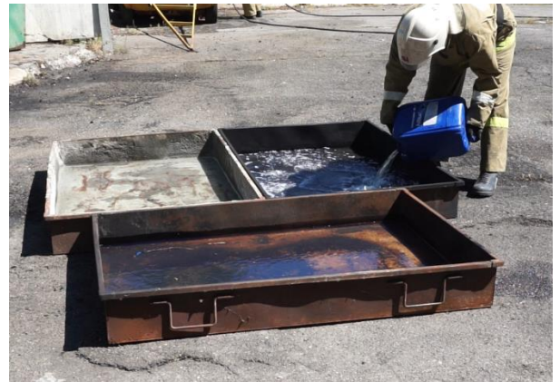
Рисунок 3.6 – Порционное смешивание воды (слева) и бензина (справа) для модельного очага 144В
