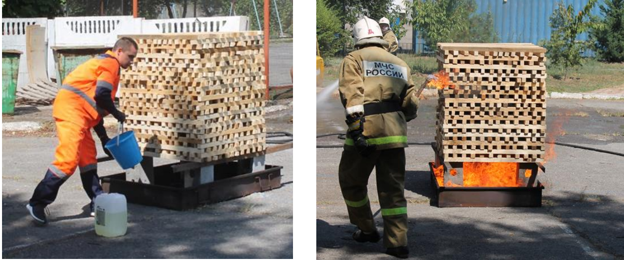
Рисунок 3.4 – Процесс подготовки модельного очага 10А (слева) и его поджог (справа)
