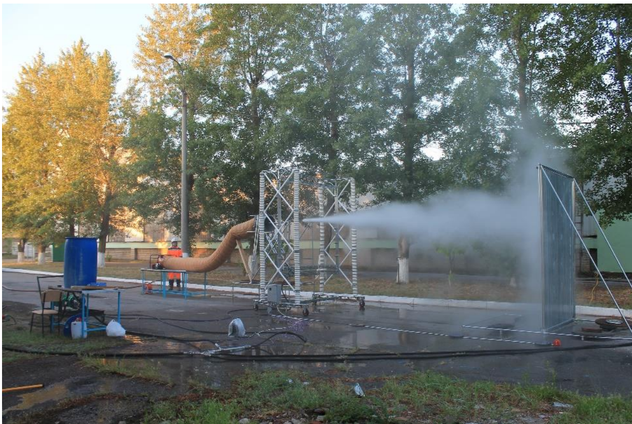
Рисунок 3.11 – Опытно-экспериментальный стенд для проведения исследований по электропроводимости струй температурно-активированной воды
