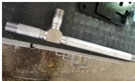
Рисунок 2.20 – Образец выбранного дозатора (слева) и смесителя (справа)
