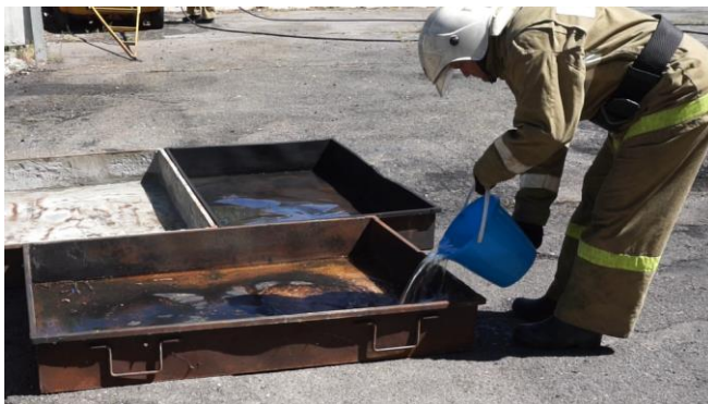
Рисунок 3.6 – Порционное смешивание воды (слева) и бензина (справа) для модельного очага 144В
